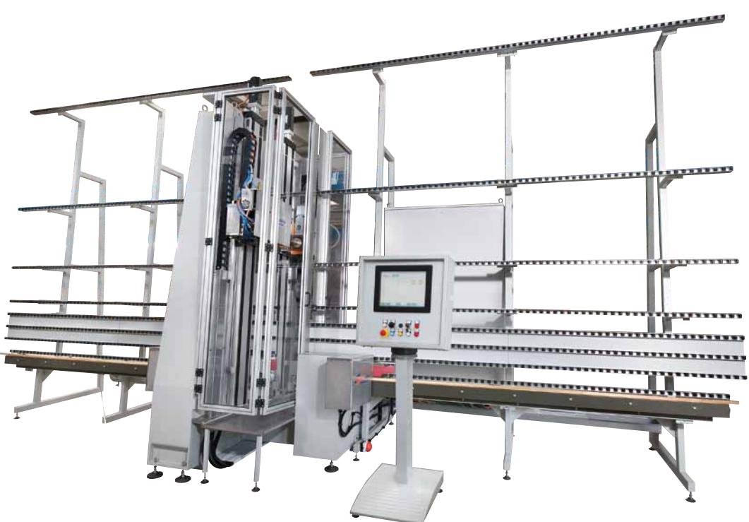
La struttura di tipo **OPEN TOP** e permette il transito di lastre di qualsiasi dimensione mentre l'altezza max. di fresatura / foratura è a 2000 mm.
